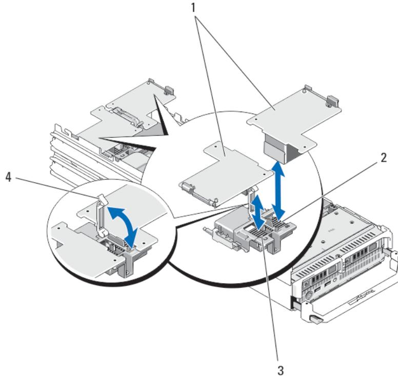
**Figure 11. Retrait et installation d'une carte mezzanine PCIe**
