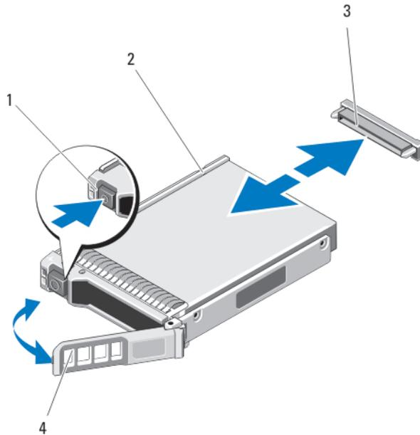
Figure 17. Retrait et installation d'un disque dur/SSD
