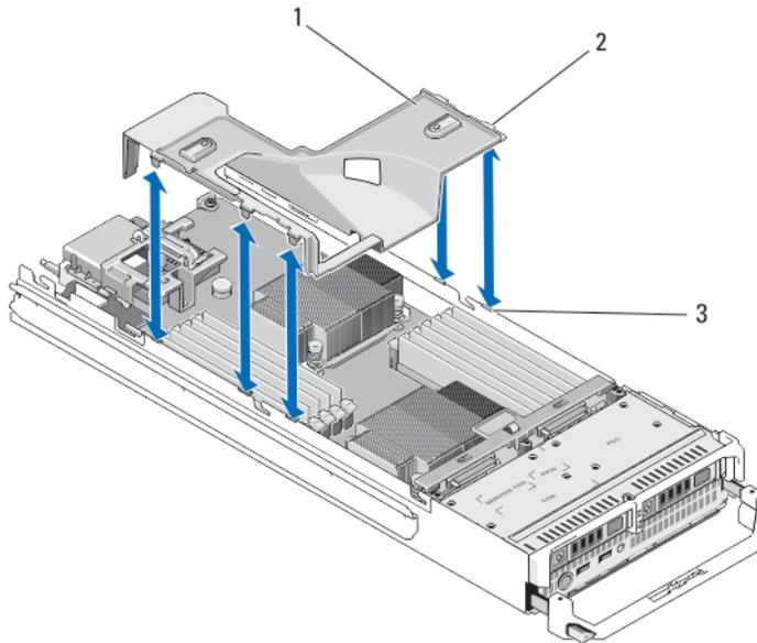
**Figure 8. Retrait et installation d'un carénage de refroidissement**
