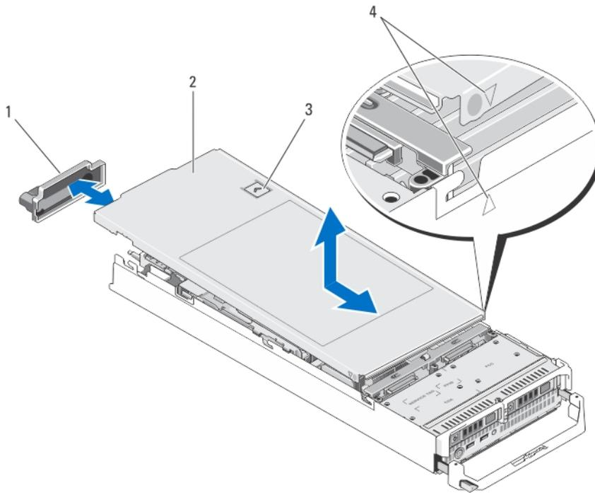
**Figure 6. Ouverture et fermeture du module serveur**
