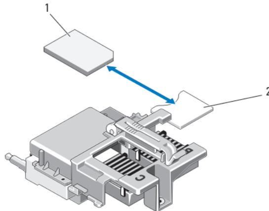
Figure 14. Remplacement de la carte SD vFlash
