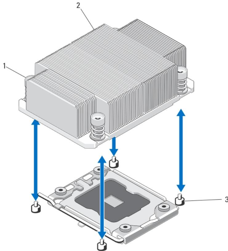
**Figure 15. Retrait et installation du dissipateur de chaleur**
