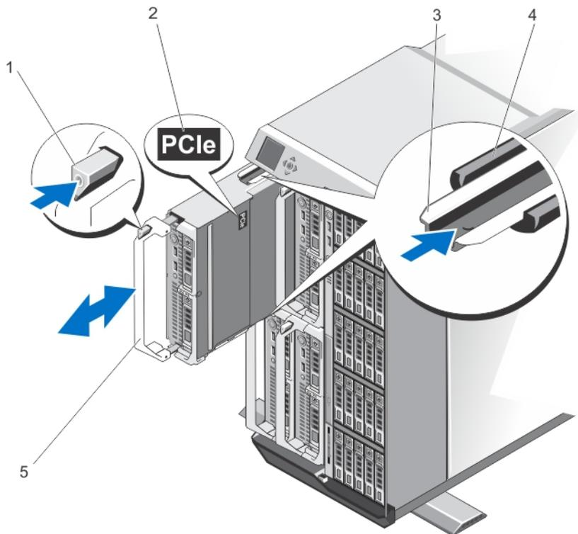
Figure 5. Retrait et installation d'un module serveur
